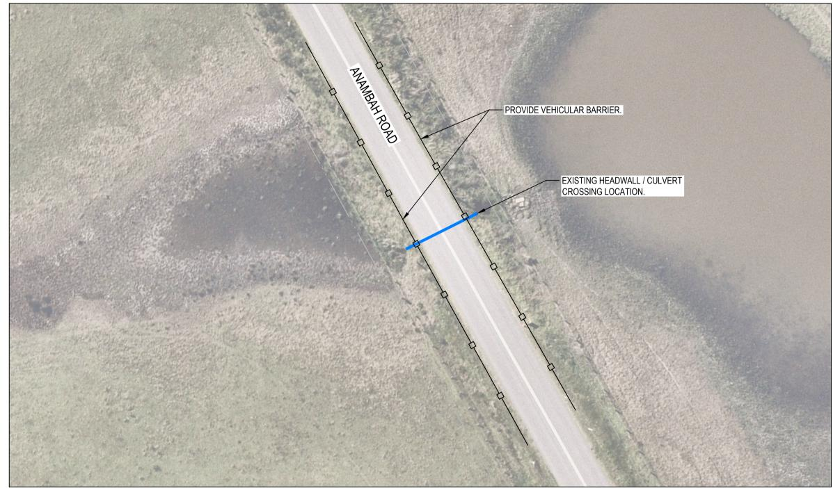
ITEM 2 - CULVERT LOCATION ON STRAIGHT ALIGNMENT (CH2800)
